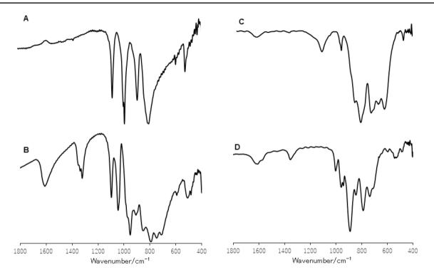
Fig. 1 FT-IR spectra of a Cs-P-Pt-800-5, b Cs-P-Pt, c Cs-Si-Pt-800-5, and d Cs-Si-Pt
