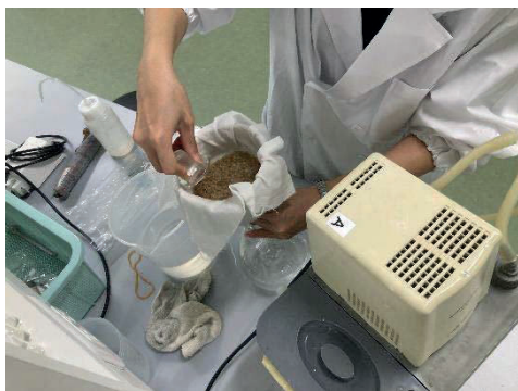
図 1. 漂白パルプ洗浄の工程
