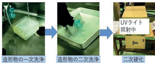
図2.製品の一次、二次洗浄と二次硬化
