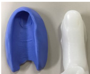
図 23 偽造生体 (熱可塑性樹脂) Fig. 23 Counterfeit (thermoplastic resin).
