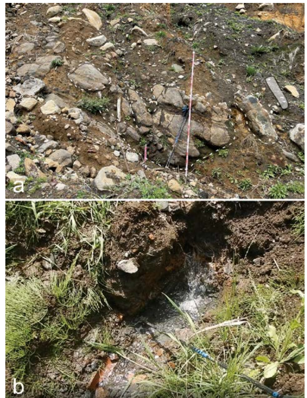
図10 崩壊地内部の安山岩ブロックと湧水状況。a: 差し渡し2mの安山岩ブロック (図6のii)。小ブロックに割れていて、間に土砂が詰まっていることから、地すべり1の一部と推定される。スケールは2m。b: 盛土下からの湧水 (図6のiii)。亜円礫が認められることから、おそらく背後に砂礫層があるものと推定される (2022年5月2日撮影)。
