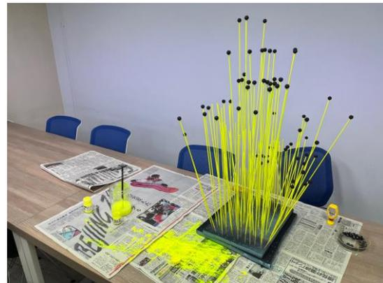
図5：先端のカバーと蛍光塗料の塗装
