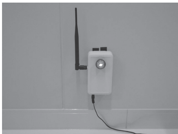
図7 洗浄用ドラフト室に設置した 警報ボタンユニット
