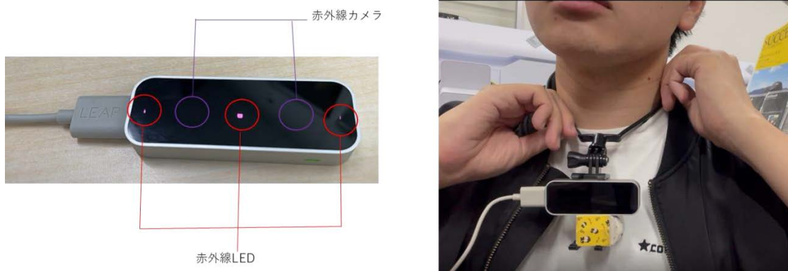
図 4-6 Leap Motion Controller の概要及び装着図
