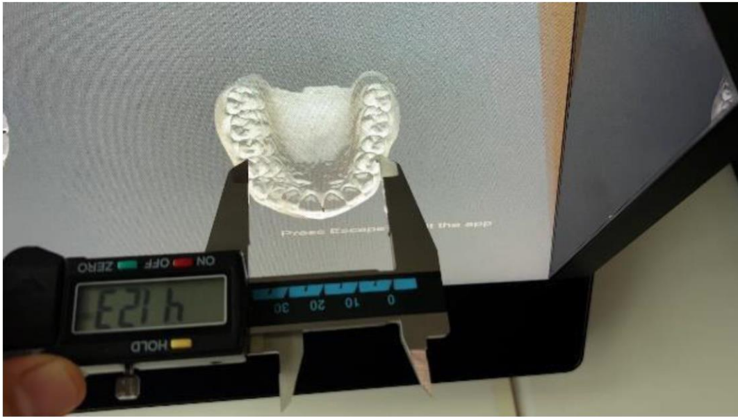
図 4-5 空間再現ディスプレイ(SRD)による 3D-CG モデルの測定[4]
