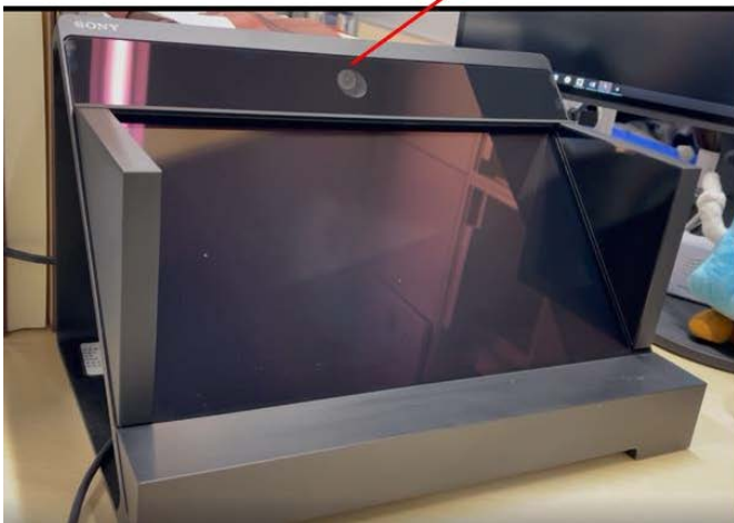
図 4-2 空間再現ディスプレイ(SONY ELF-SR1/BZ)における視線認識センサ
