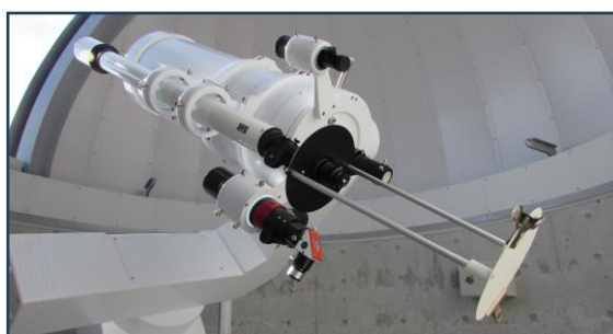
今年度設置されたL型フォーク式30cm カセグレン反射望遠鏡（中央工学）
