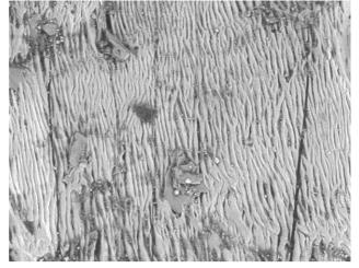
は不明であるが、ヒマラヤからのものと思われる。規則的な波状の形状を持つ破断面が見られた。 このようなものはこの 1 例だけなので、このような破断面が普遍的かどうかはまだわからない が、破断メカニズムを検討する価値がある映像と思われる。今後更なる検討を経て有益な結果が期 待できる。
