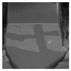
圧状態にさらされていることで、破断面が結晶成長の場となっていることがわかった。新たに形成された角閃石はマイクロブーディン構造を呈している角閃石 (グロコフェン)とは違う化学組成をもっているので、マイクロブーディン破断面を識別することは可能で、現在までにわかったことは、破断面は比較的直線的な面であることがわかった。この方法では、新たに成長した角閃石がマイクロブーディン破断面の復元を困難にしていることを確認した。
