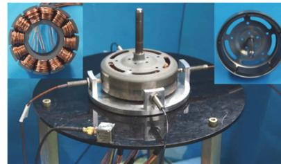
図7 試作した四相非対称ベアリングレスモータ
