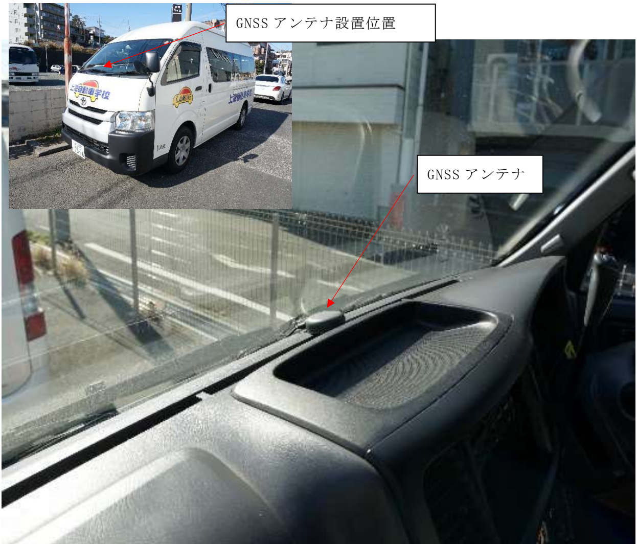
図 51 GNSS アンテナ設置状況
