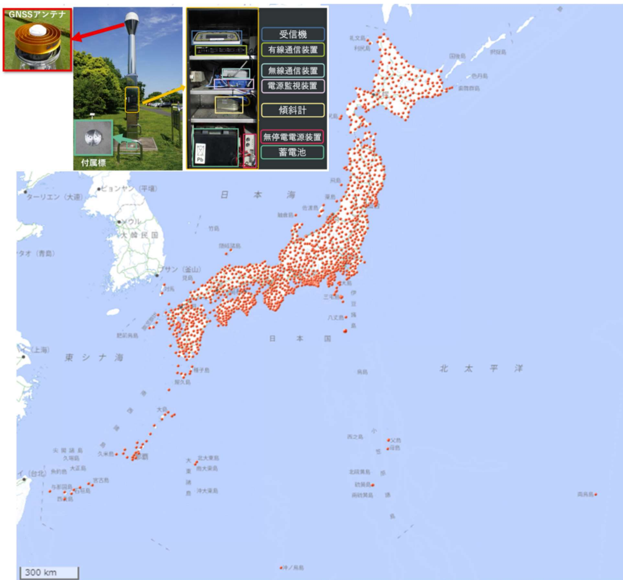
図 7 電子基準点配転図（令和 4 年 4 月 1 日時点）と電子基準点内部の機器構成
