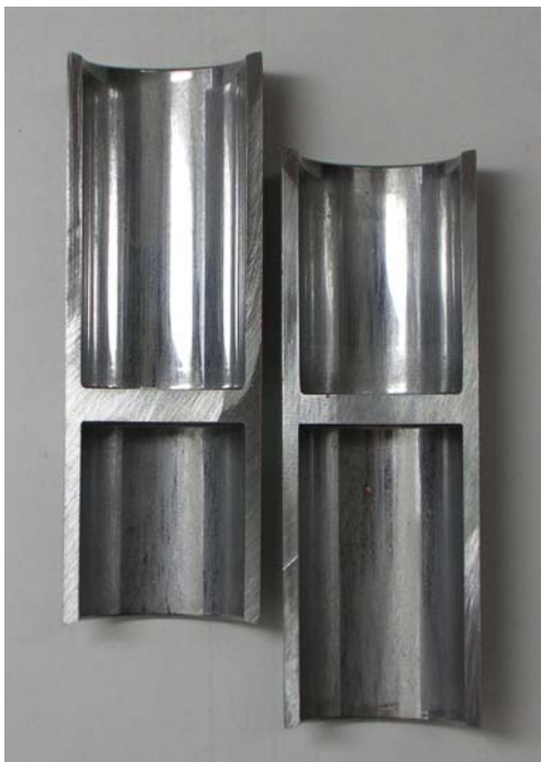
Fig.5-5 S10C でのベアリング長さの効果 (左 B=0.5 右 B=5 )
