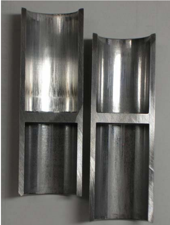
Fig.5-11 WCL 形試験での加工速度の影響 (S10C 左 : 80mm/s, 右 : 3mm/s)
