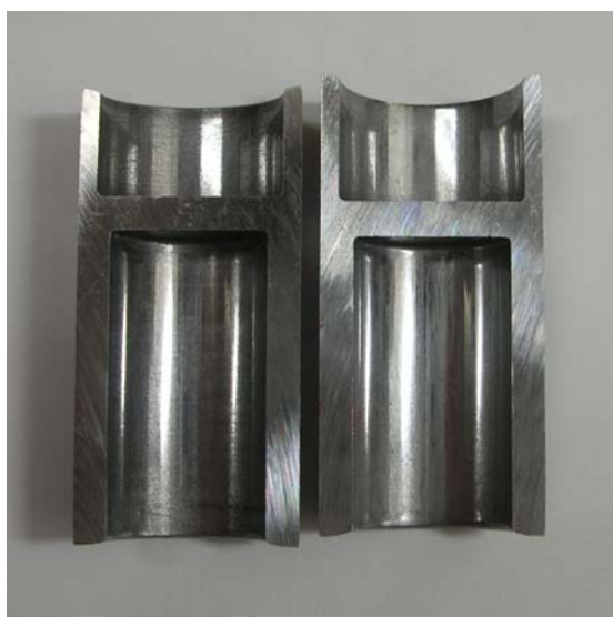
Fig.5-9 加工速度による WC 形試験変形状の変化 (左: 80mm/s, 右: 3mm/s)
