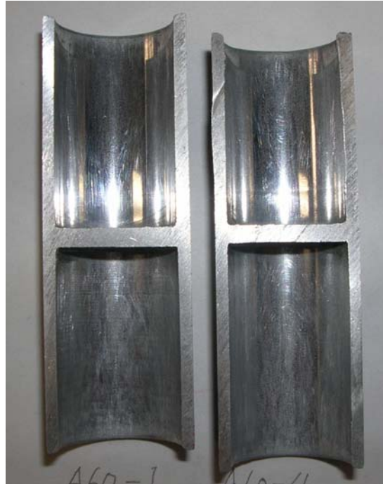
Fig.5-12 WCL 形試験での加工速度の影響 (A6061 左 : 80mm/s, 右 : 3mm/s)
