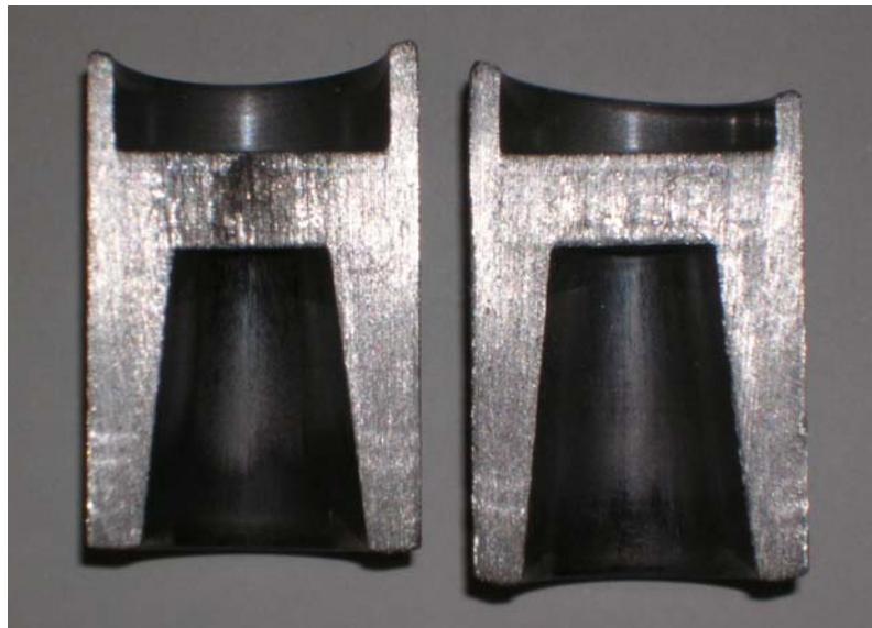
Fig.8-4 加工速度による試験片形状の変化 (左: 3mm/s 右: 80mm/s)
