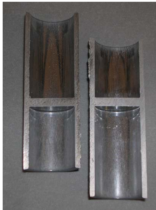
Fig.5-6 A6061 でのベアリング長さの効果 (左 B=0.5 右 B=5 )
