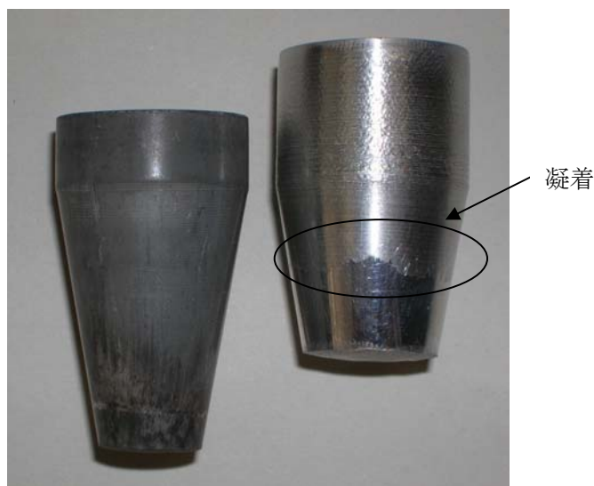
Fig.3-7 RC 形摩擦試験法の試験片 (左 : フッ化アルミ皮膜 右 : VG1000)
