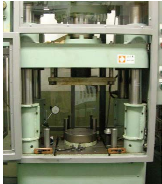
Fig.3-4 油圧式プレス外観
