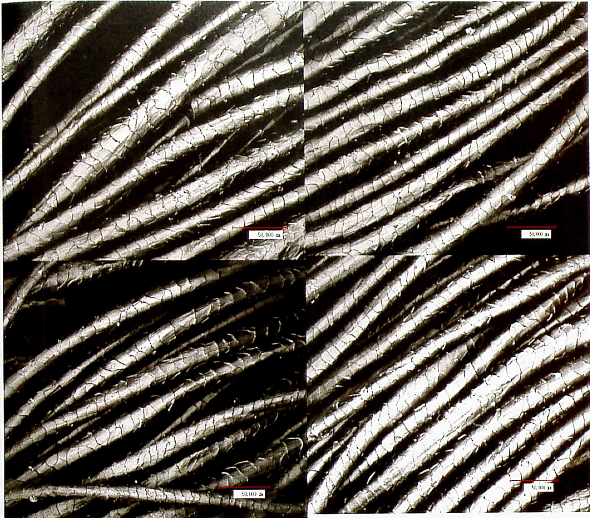
図 3-9 アルゴンプラズマ照射の有無および乾湿状態における羊毛繊維集合体の超深度 3次元形状測定光学顕微鏡写真
