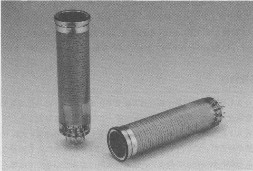
図 6.8 高解像度型 CdTe ビジコン
