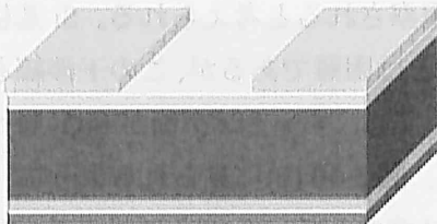
図3-7 Si電子線透過膜の作製プロセス
