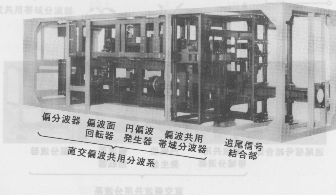
図2.51 インテルサットV号系標準A地球局アンテナ用給電系の外観
