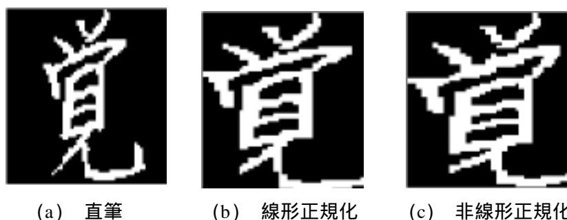
図5 - 11 非線形正規化による文字外形の調整例
