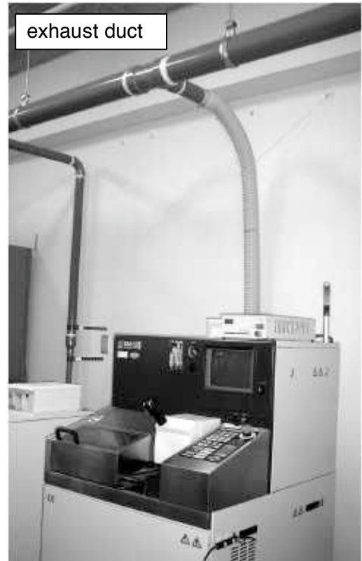
Fig.1 ダイシングソー用ユーティリティの製作と接続
