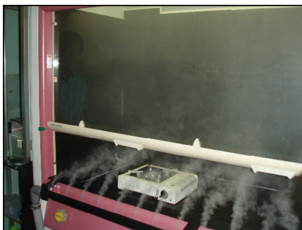
(図8 フード内に熱源がある場合の気流)
