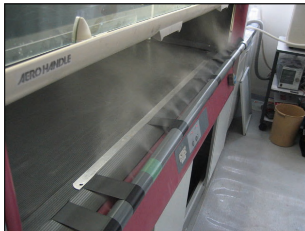
(図 11 横風を受け吸引気流の乱れる様子)
