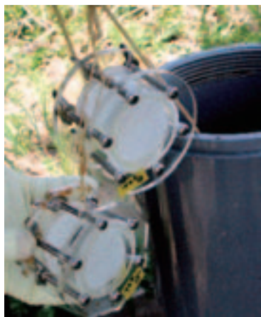
図 4 掘削井水中の細菌増殖速度の測定に用いた拡散容器(ディフュージョンチャンバー).
