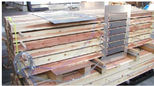
図3 実大材の積積みと電極対
