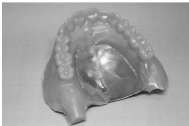
図 16 インクリメンタル成形床を用いた試作例
