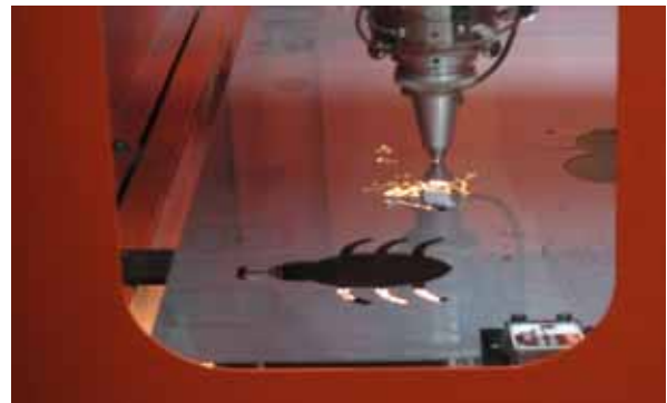
図8 レーザで加工
