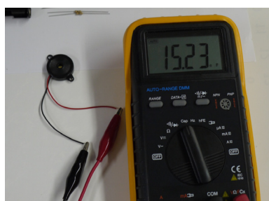
図7 圧電スピーカの測定
