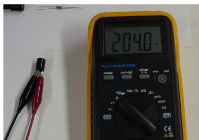
図8 インダクタの測定
