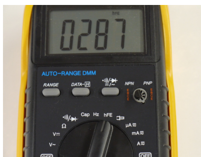
図3 h_{FE} 測定
