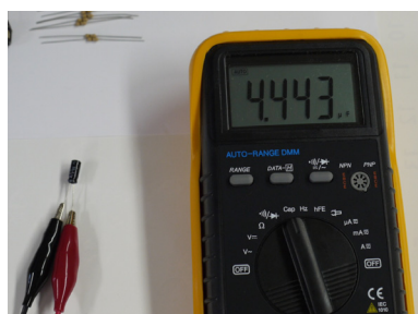
図6 電解コンデンサの測定
