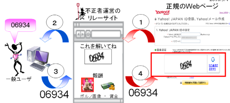
図 2. リレーアタックの仕組み Figure 2: An overview of Relay attack
