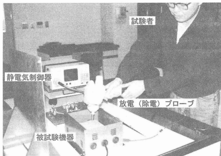
図1.8 産業用電源装置に対する静電気試験（試験室）
