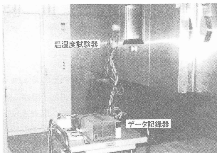
図1.4 車載用電子機器に対する熱衝撃試験（試験室）
