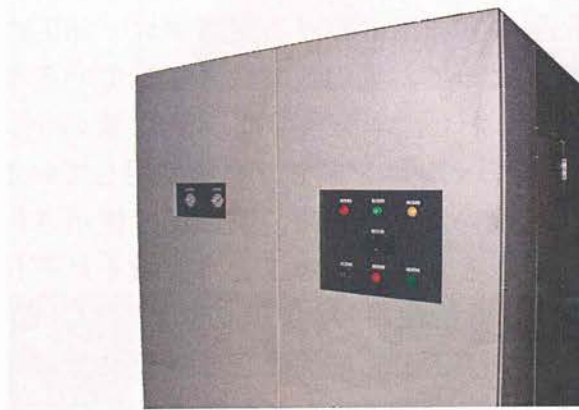
Fig.6.48 窒素発生装置外観
