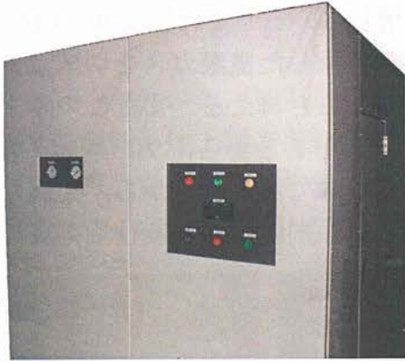
Fig.4.27 窒素発生装置外観
