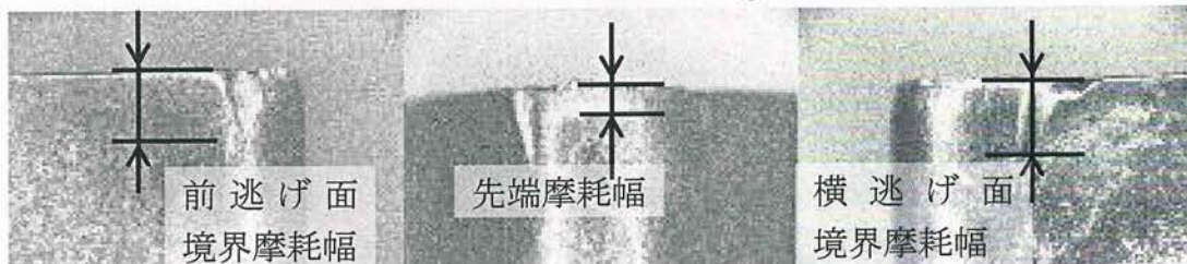
Fig.6.6 工具摩耗の計測方法
