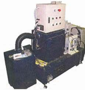
Fig.4.26 集塵機及び圧縮機
