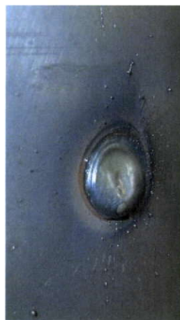
図 3.24 溶融部の流動の様子
