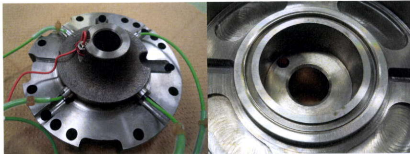
図 4.11 試作したフレーム外観（左）及び主軸受部内面（右）
