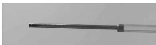
図 3.2 金薄膜を蒸着されたコア
