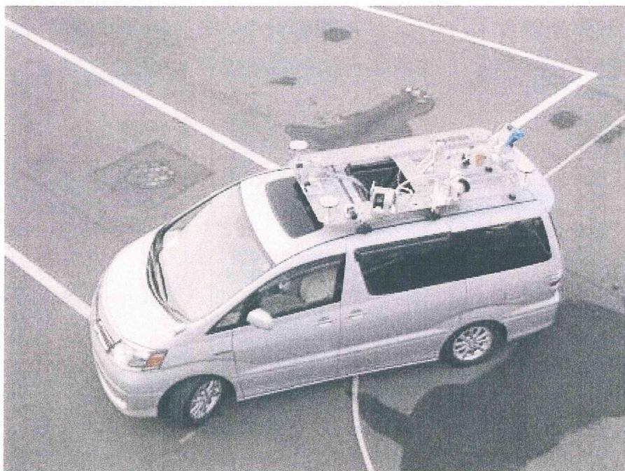
図 2.3 モービルマッピングシステム (MMS: Mobile Mapping System) 車両概観
