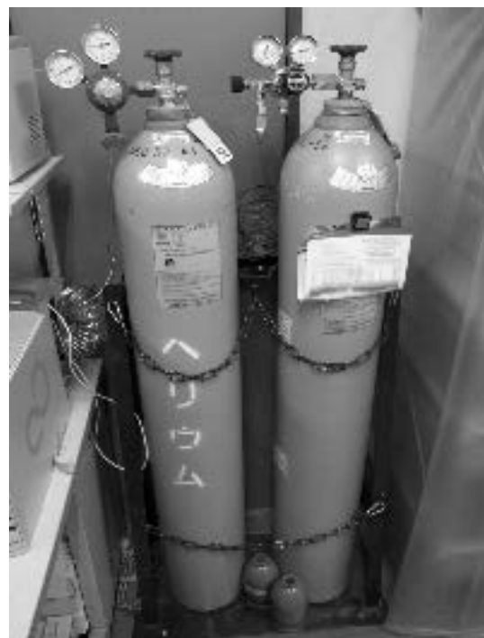
図2 実験室内のボンベ 1本ずつきちんと固定する
