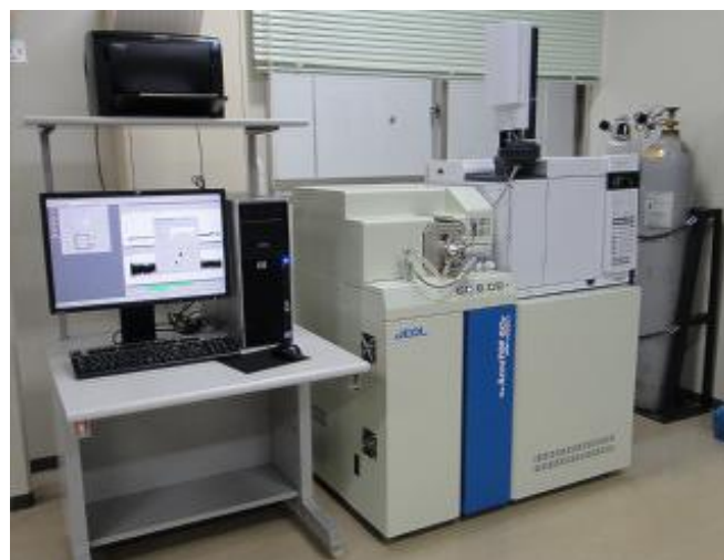
図1 静岡大学機器分析センター設置のガスクロマトグラフ-質量分析計 (JMS T100GCv、日本電子)
