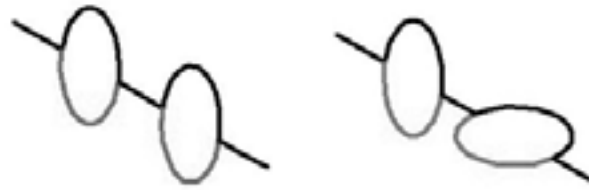
図17 直列連通型コイルの角度の変化
