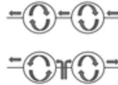
図15 直列連通型コイルと並列連通型コイル
