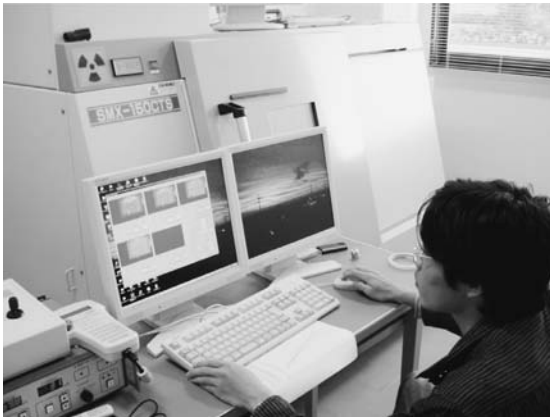
図2 筆者の研究室で試作したフォトンカウンティングCT装置 左：外観写真 右：内部写真 手前から線源、被写体、検出器。
