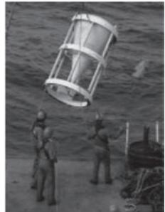
図36 沈降粒子の採取
