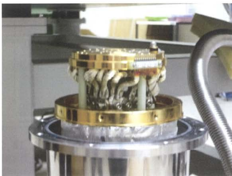
図 3.19 無酸素銅繊維によるコールドヘッド、ワークサーフェス間の接続
