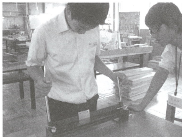
図9 アルミ板の折り曲げ
