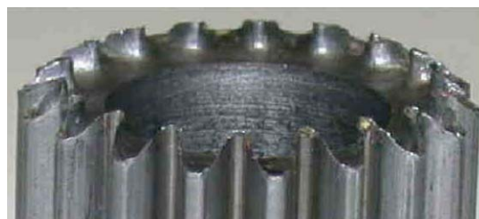
図1 外径絞り押出しでの成形品後端面 (モジュール 1.25 歯数 18)
