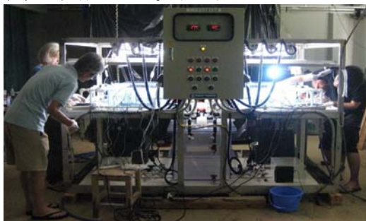
図1 環境条件制御型サンゴ飼育実験装置
