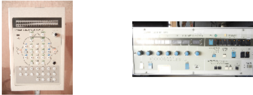
図 4.4.6 脳波電極箱（左）と脳波計（右）（日本電気三栄株式会社 製）
