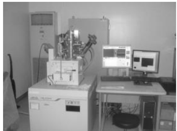
写真 1. 複合ビーム観察加工装置 JIB-4500
