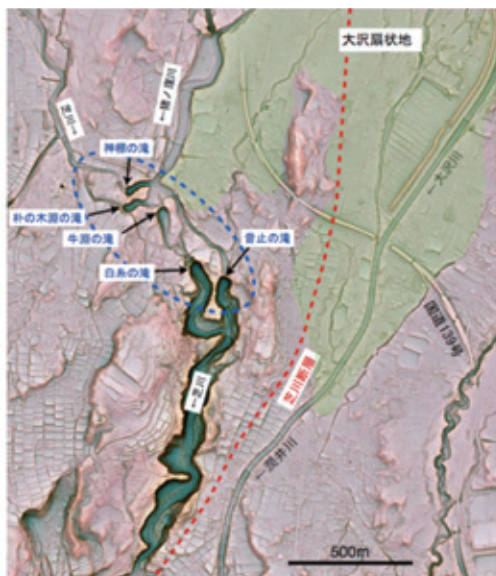
口絵3 白糸の滝付近の地形と芝川断層・大沢扇状地の関係／背景図は国土交通省富士砂防事務所提供
