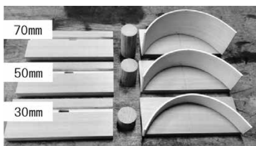
図4. スピーカーの高さ (h=30mm 50mm 70mm)
