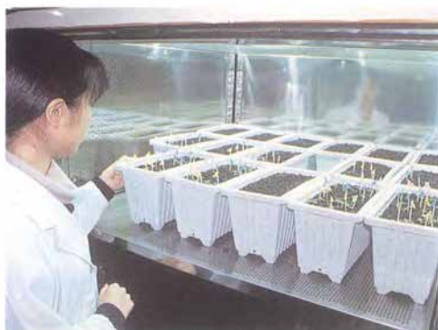
写真4-16 環境調節装置を使った発芽実験
