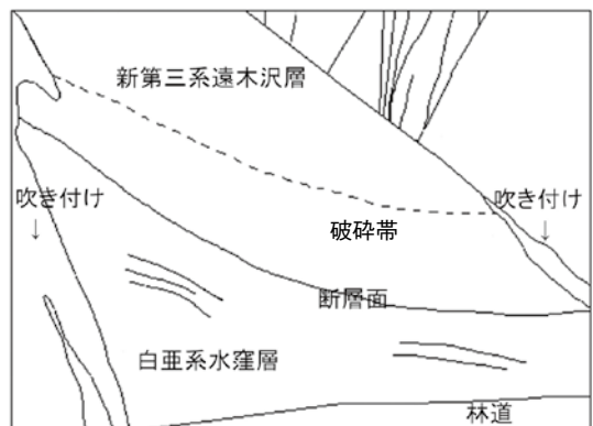
図3. 露頭Aのスケッチ. 不整合面を境に新第三系遠木沢層と白亜系水窪層にはっきりと分かれている。断層面は不整合面に由来した可能性もある。
