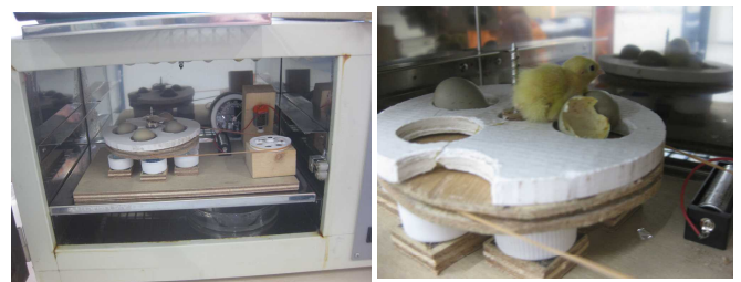
図19 完成した自動転卵装置に入卵した状態(左)と雛が孵化した様子(右)
