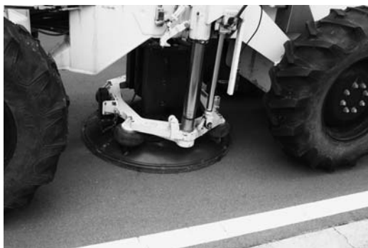
図7. 中型起振車の丸いベースプレート
