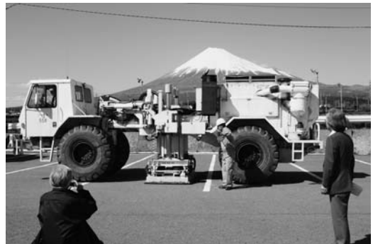
図5. ベースプレートを地面に押し付け振動を送っている起振車
