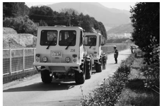
図10. 2台が一线になって動いている起振車
