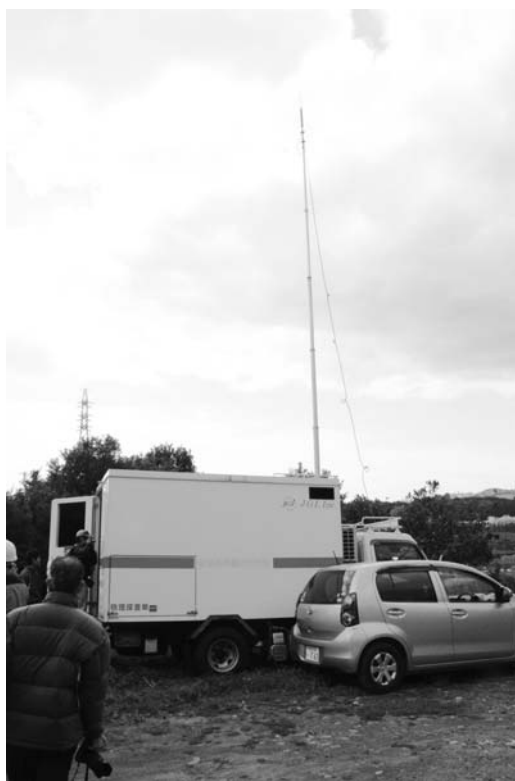
図8. 高いアンテナのついている観測車
